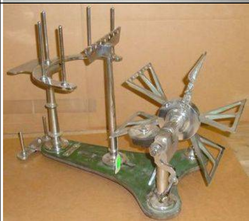
05381-1 Wollspulmaschine Original, England, vollständig aus Metall, auf Bodenplatte 65 x 39 x 44 cm
