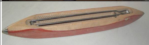
05377 Weberschiffchen Originale, alt, Holz mit Metallmechanik innen 45 cm lang
